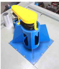
พัดลมหมุนเวียนลมร้อน
